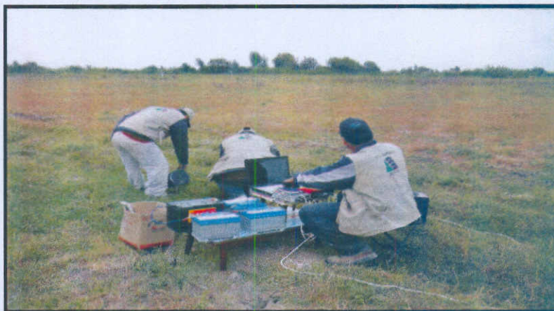
Prospección Geofísica en el valle Chicama. Se observa el equipo y el cableado necesario para la ejecución de un sondeo por transitorio electromagnético – TDEM
