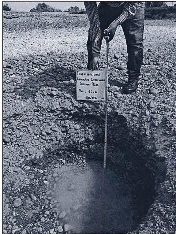
Figura 20.- Calicata CRCH-02 Deposito de Gravas arenosas con nivel freático somero.
