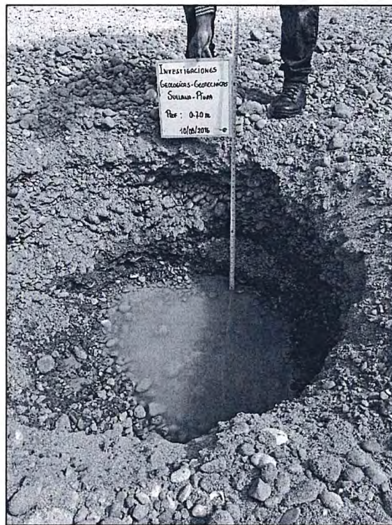
Figura 21.- Calicata CRCH-02. Depósito de gravas. NF somero.
