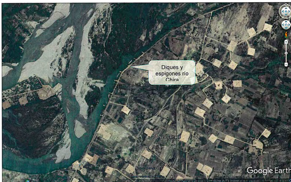
Figura 8. Defensas ribereñas, condicionan la delimitación del eje del río Chira
