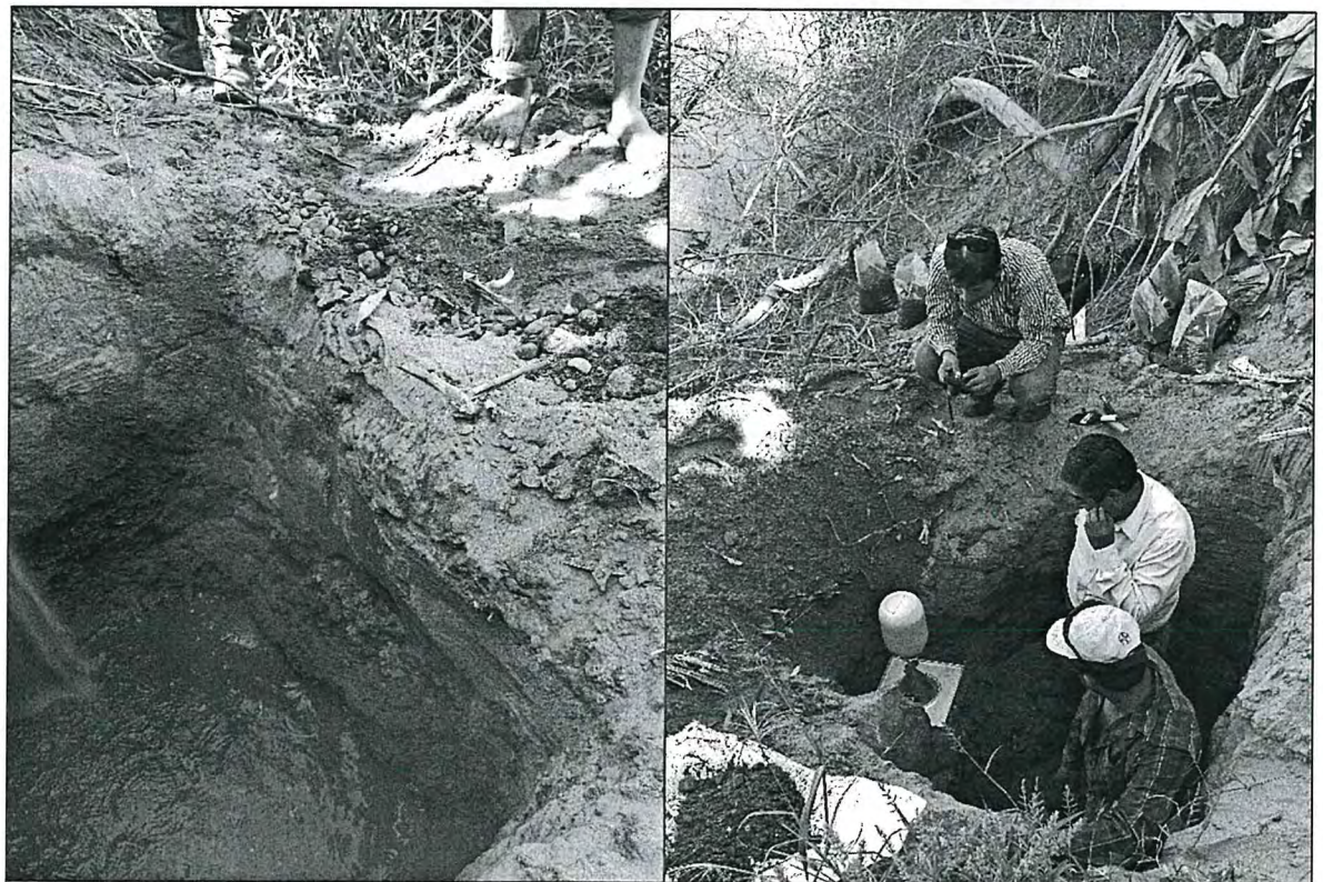
Figura 22.- Calicata CRCH-03. Arena fina a media en la parte superior.
