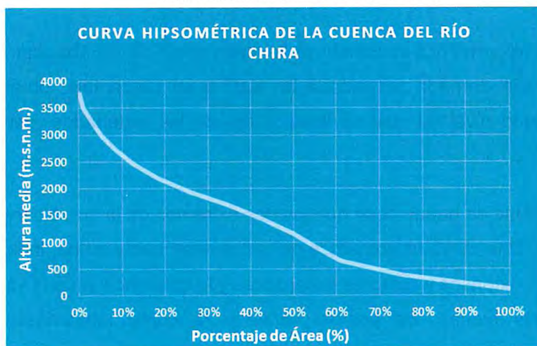
Figura 3. Curva hipsométrica del río Chira
