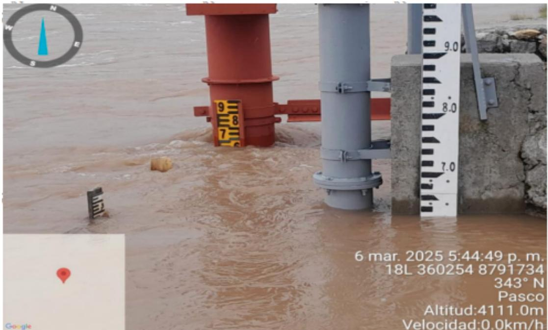
**Fotografía N° 04:** Tirante de agua del río Mantaro en la mira limnimétrica = 6.2 pies
