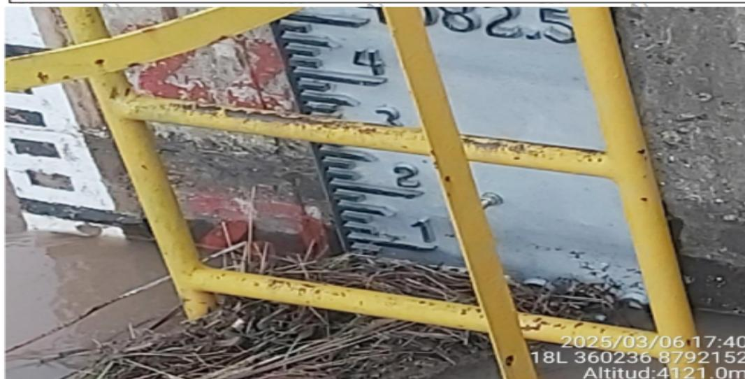
**Fotografía N° 02: Nivel del embalse en la presa Upamayo = 4082 m.s.n.m.**
