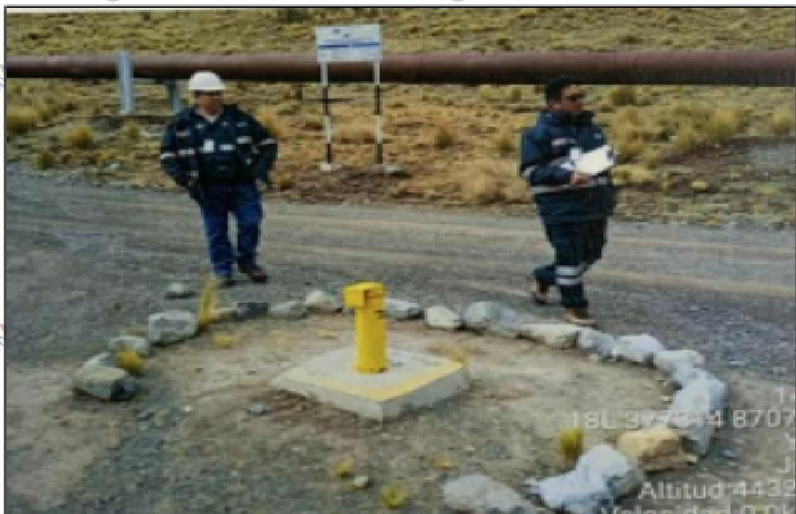
**Fotografía 03:** El piezómetro se ubica en la UM Toromocho
