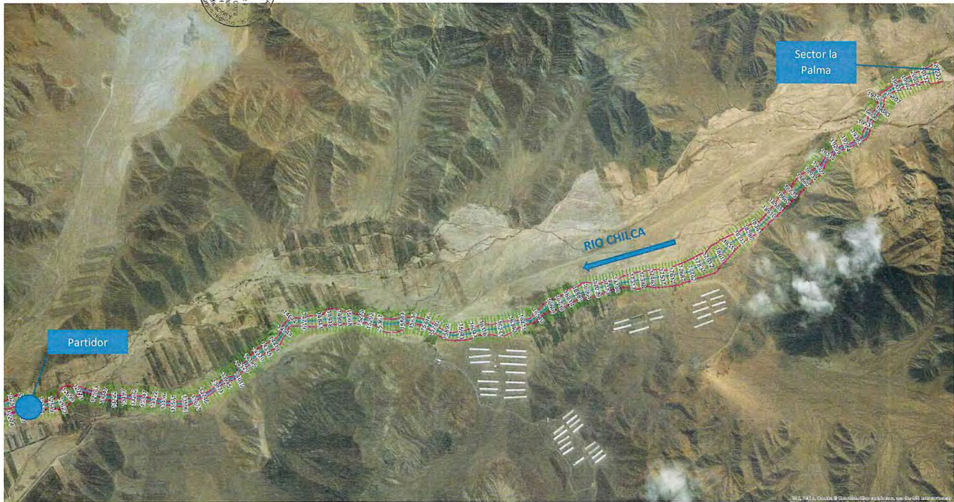
Figura N° 2: Secciones transversales a ser utilizadas por HEC-RAS, aguas arriba del partidor
