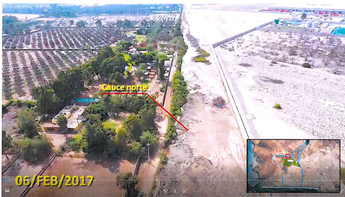
Foto 6: Vista aérea aguas abajo del cauce artificial, se aprecia desbordes del flujo por la presencia de desmontes en el cauce.
