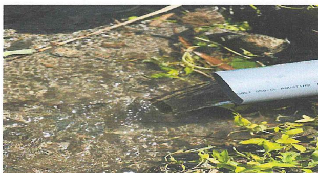
Imagen 2: Aforo volumétrico realizado
