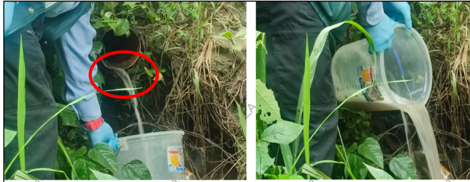
Fotografía N° 02. Descarga de aguas residuales del lavado de autos y demás por una tubería HDP de 4".
