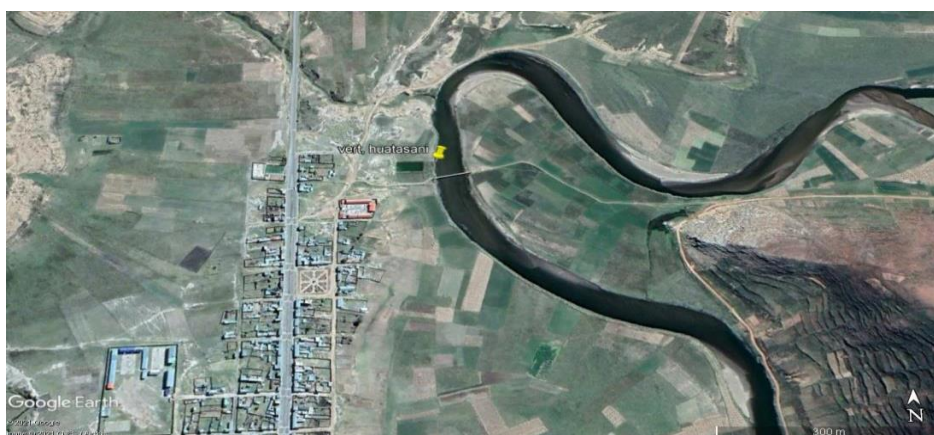
Figura N° 4.- Mapa de ubicación del punto de vertimiento de agua residual a cargo de la Municipalidad Distrital de Huatasani al cuerpo natural del río Huancané.
