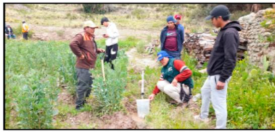
**Foto N° 04:** Vista Fotográfica de fecha 22.01.2024, manantial Condor Collo, donde se realizó el aforo de agua por el método volumétrico.
