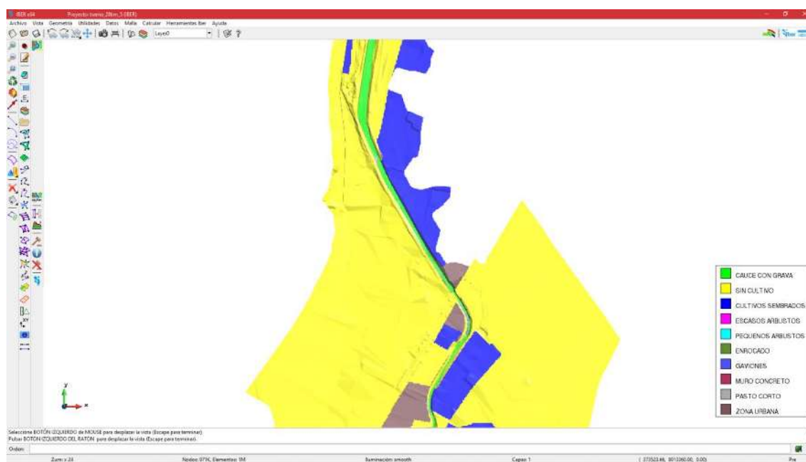
Figura 39 Coeficiente de rugosidad de Manning en puente Piedra Blanca
