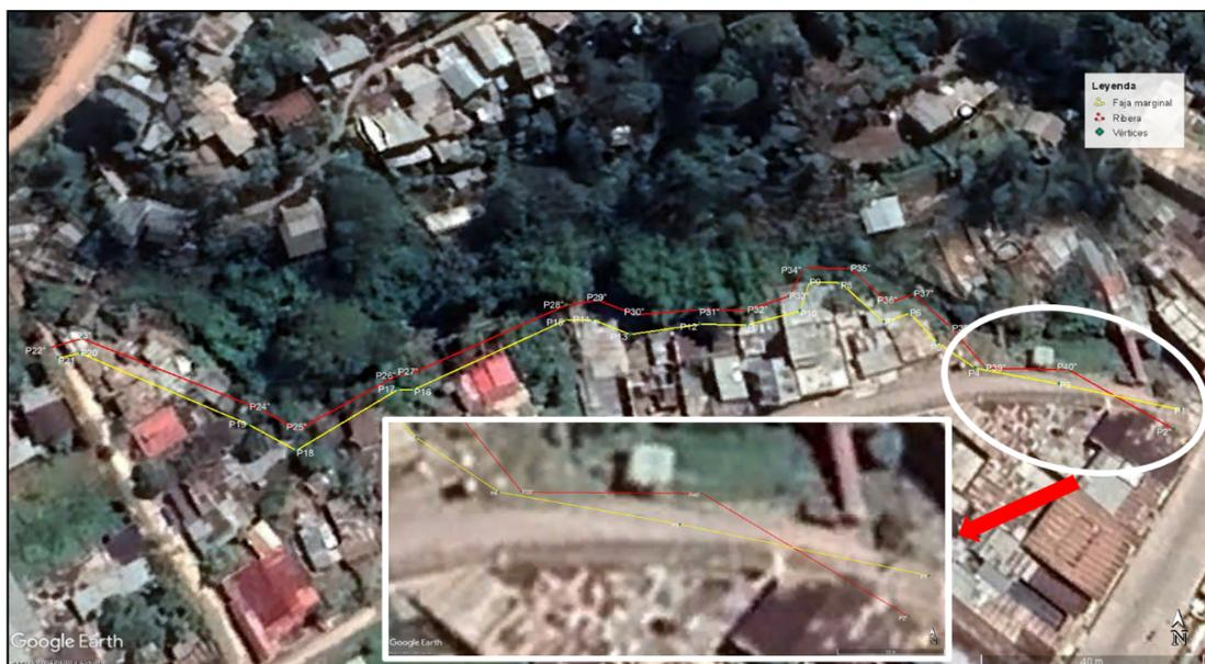
**Figura 2.** Replanteo de los vértices del límite exterior de la faja marginal
