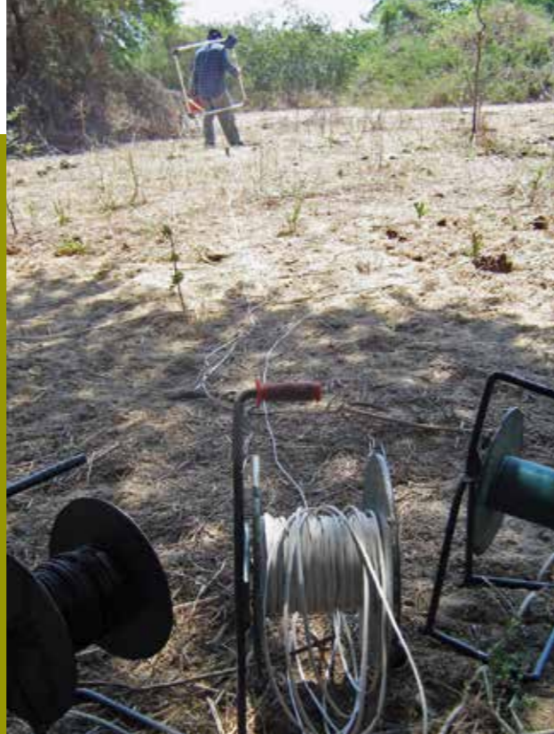
Figura 1. Equipo geofísico desarrollado por el Instituto Siberiano de Geología, Geofísica y Recursos Minerales de Novosibirsk, Rusia.
