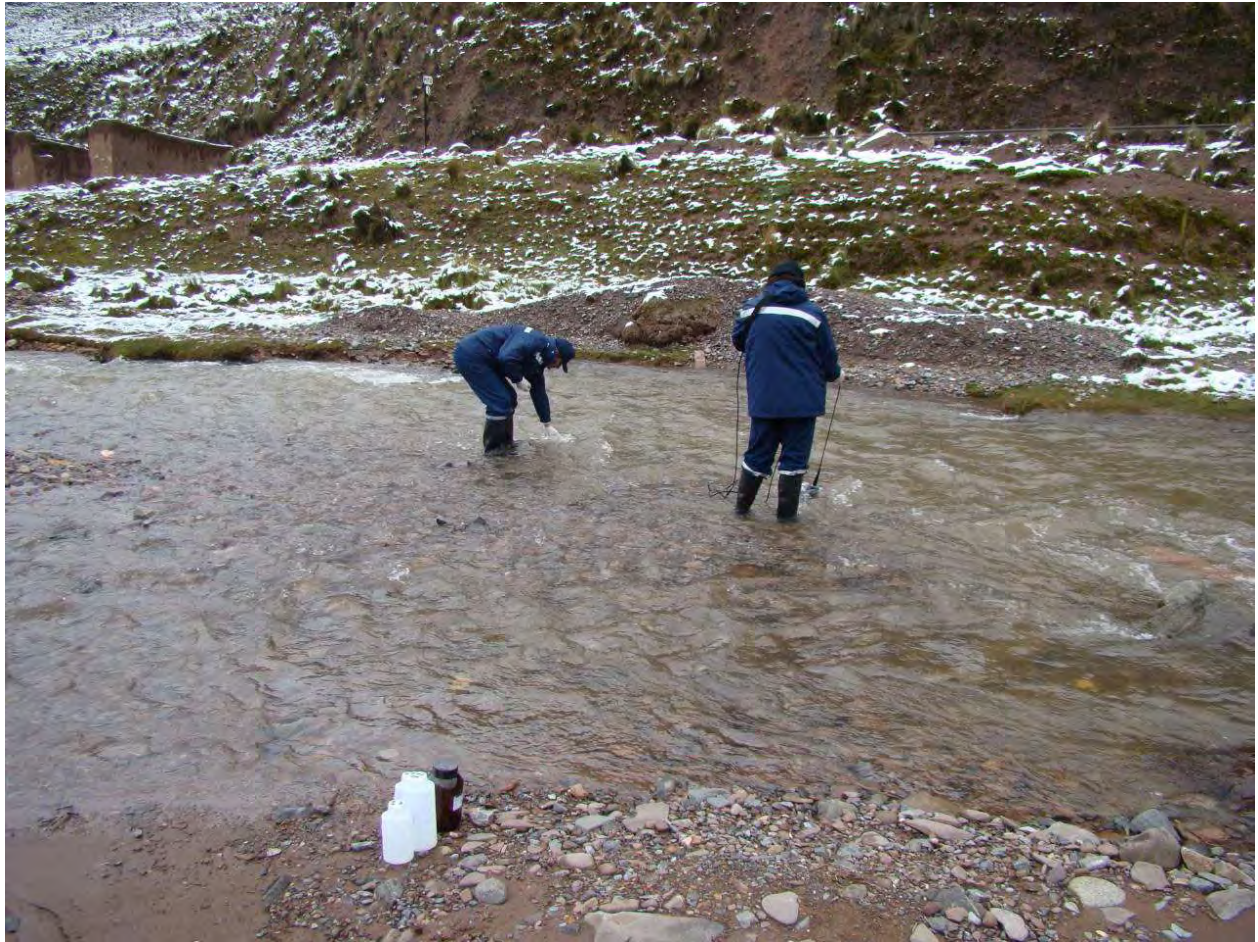
E-02: Río Chinchán, puente Ferrocarril: toma de muestras y medición de parámetros de campo.
