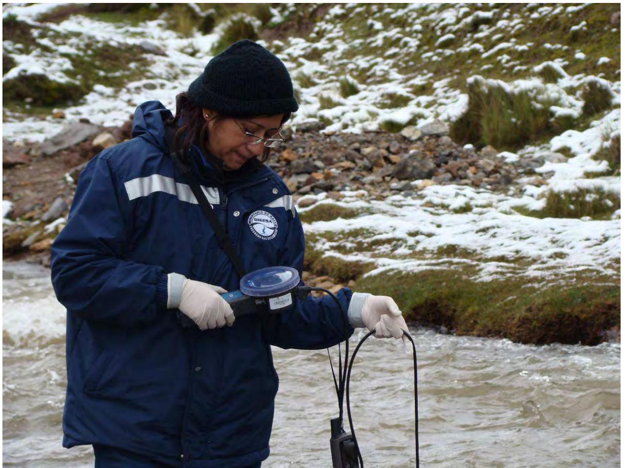
E-02: Medición de parámetros de campo: pH, temperatura, conduct.esp., turbidez y oxígeno disuelto.
