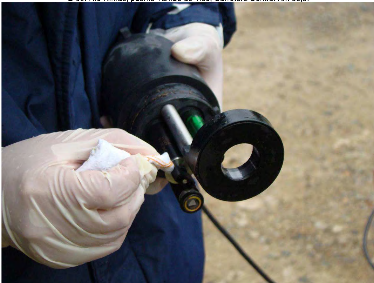
Limpeza de sólidos impregnados en los electrodos del equipo multiparamétrico.
