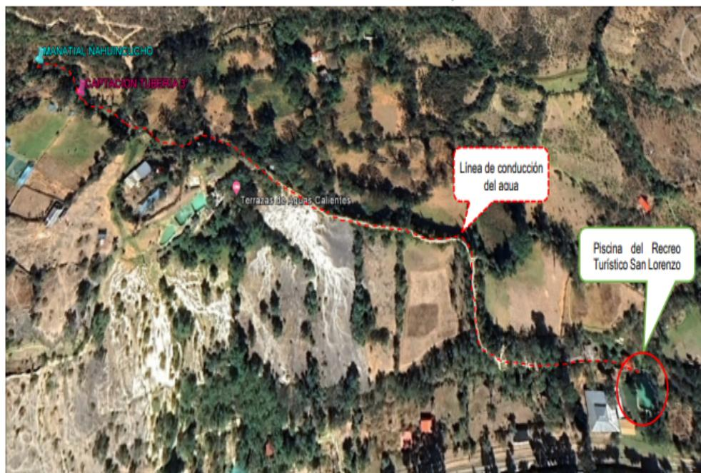
Fotografía N° 01: Captación consistente en una tubería hdpe de 3" con un caudal aproximado de 1.5 l/s, ubicado en las coordenadas UTM WGS 84 497834E, 8622878N, que conduce las aguas al "Recreo turístico San Lorenzo"
