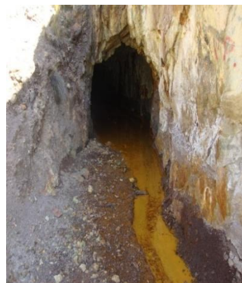
Bocaminas abandonadas con flujo de agua de Cía Minera Gemanio. – Río Aruri
