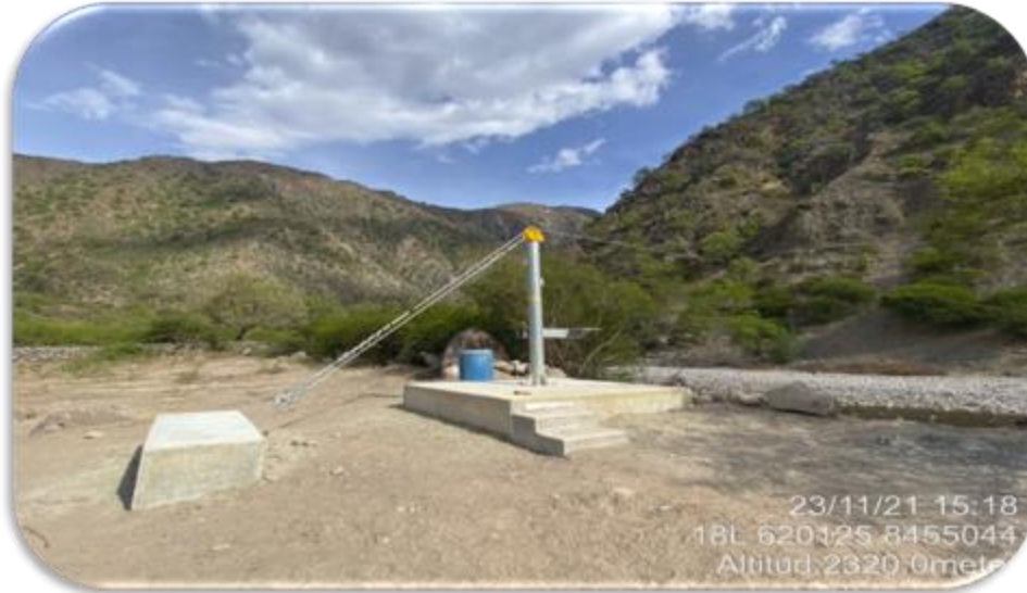
Figura N° 2 Sistema de Anclaje, Poste y Polea de SMA
