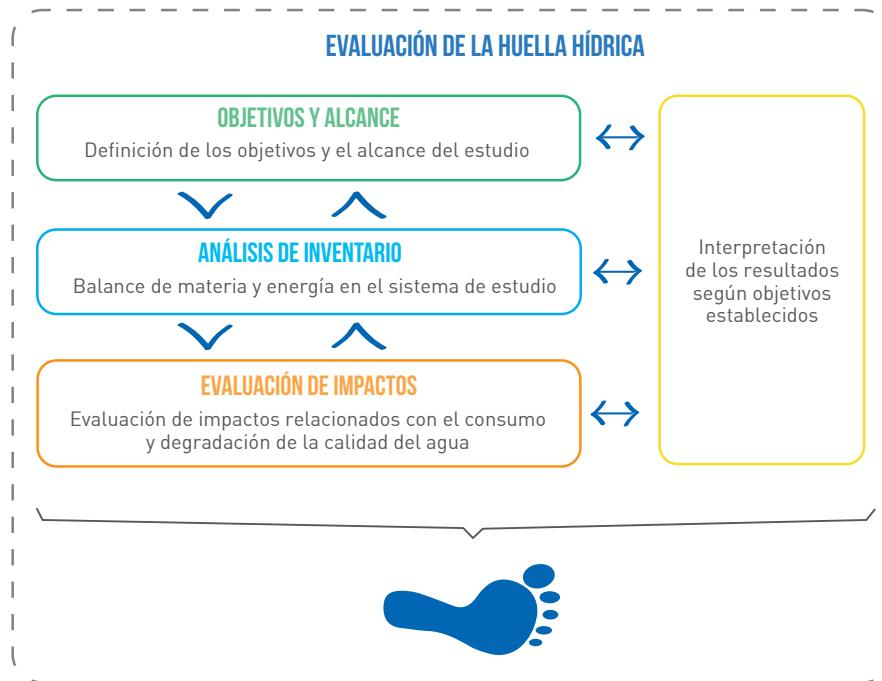
Figura 2: Esquema de las etapas para el cálculo de huella hídrica (adaptado de ISO 14046, 2014)
